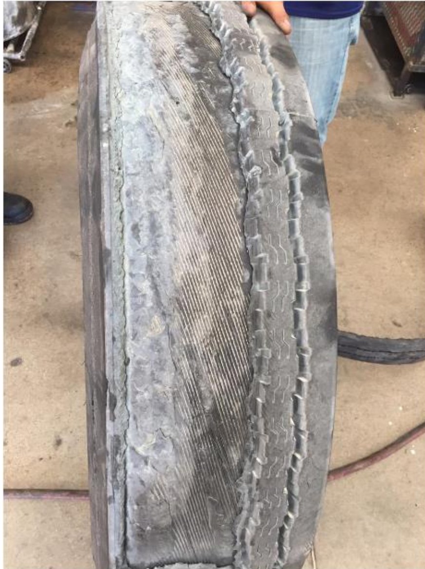
Figura 2.5 Llanta con reclamo de garantía (desprendimiento de Banda de rodamiento).
