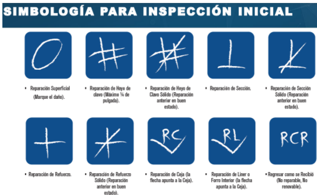
Figura 4.2 Simbología para inspección inicial.
