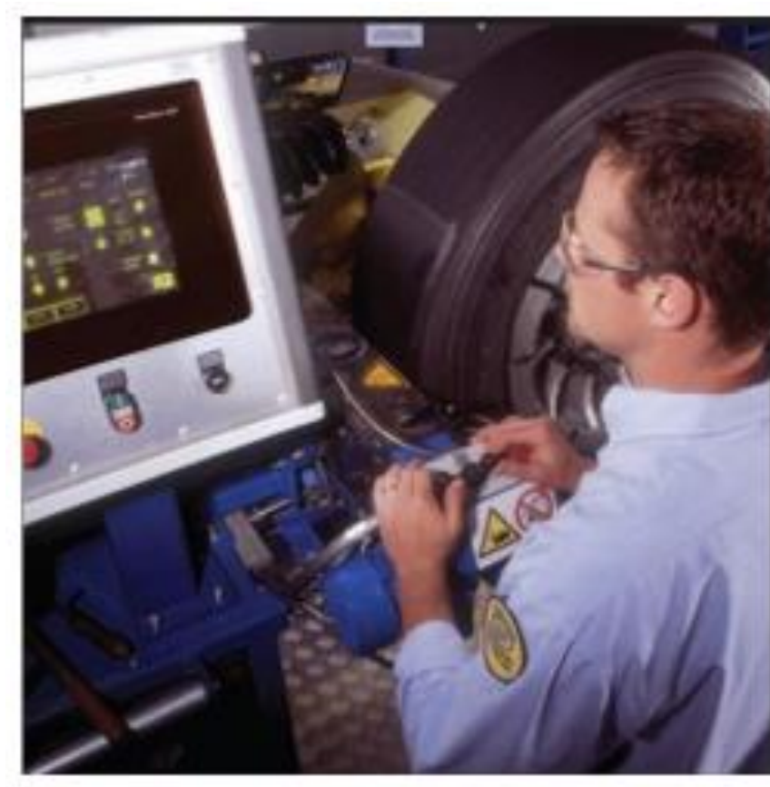
Figura 4.16 Relleno y aplicación de cojín. Fuente: (BANDAG, 2021)
