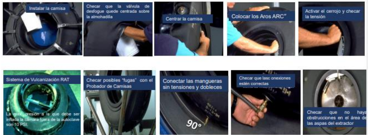
Figura 4.18 Montaje para vulcanización.
