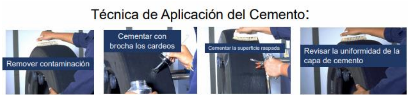
Figura 4.14 Técnica de aplicación de cemento.
